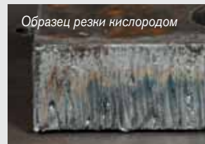
Сравнение скоростей резки для низкоуглеродистой стали толщиной 12 мм
