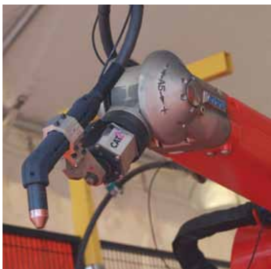
Роботизированная резка в трехмерном пространстве
