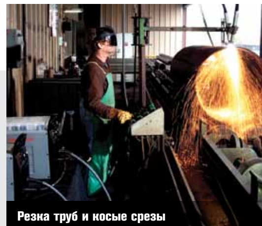
Резка и строжка по направляющей
