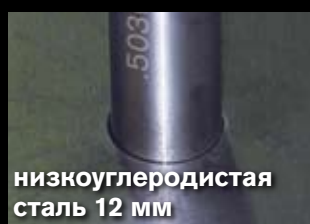
Отверстие 12 мм при использовании технологии True Hole
