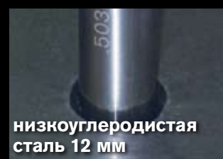
Отверстие 12 мм без использования технологии True Hole
